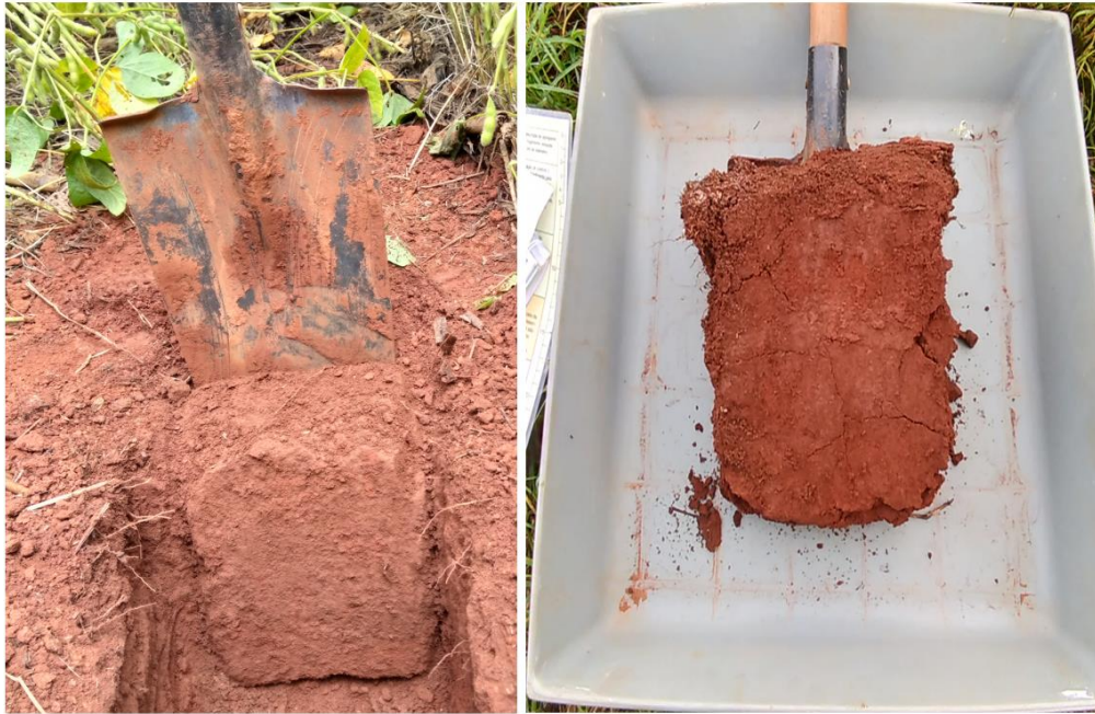
Figura 2. Estratégia de amostragem utilizada para a análise visual da estrutura do solo pelo método VESS. A esquerda, a extração da amostra, e a direita, a disposição da amostra para subsequente análise. (Foto: Guilherme Anghinoni).
