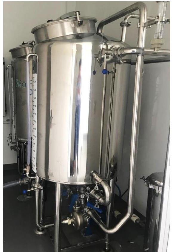
Figura 1. Biofábrica de 250 L para validação das multiplicações de bactérias no IGA.
