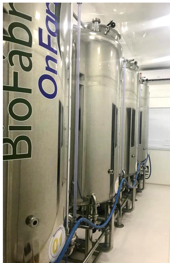
Figura 3. Biofábrica de 1.500 L para multiplicação de bactérias na fazenda
